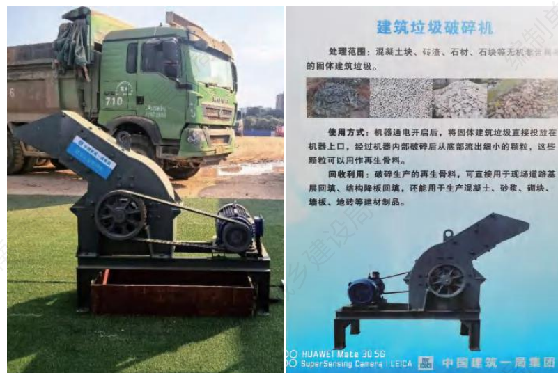
示例 14 建筑垃圾破碎机
